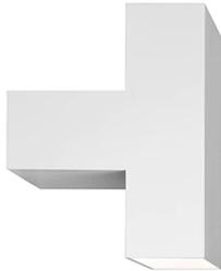
Настенный светильник прямого/непрямого света. Корпус из окрашенного экструдированного алюминия. Боковые кромки из литого алюминия повернуты под углом до 45° благодаря обработке на станке с ЧПУ для идеального сочетания с корпусом светильника. Диффузоры, изготовленные из ПММА методом инъекционного формования с фотоцинкографией. Настенное крепление из PA66, изготовленное методом инъекционного формования. Блок питания с несколькими уровнями напряжения встроен в корпус.
