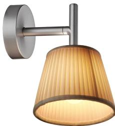
Настенный светильник рассеянного света. Внутренний штампованный диффузор из травленого боросиликатного стекла. Абажур из плиссированной ткани. Отлитые под давлением алюминиевый диффузор и держатель лампы, окрашенные в серый цвет. Настенное крепление и розетка из инжектированного поликарбоната, окрашенного в серый цвет.
