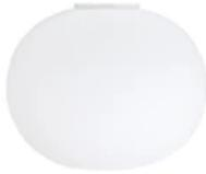
Светильник рассеянного света для настенного или потолочного монтажа. Диффузор из травленого снаружи накладного опалового стекла ручной работы с литой под давлением алюминиевой резьбовой круглой гайкой с алодиновым покрытием. Основание из инжектированного полиамида, стеклоармированного на 30%. Отлитый под давлением алюминиевый держатель диффузора, окрашенный в серый цвет.
