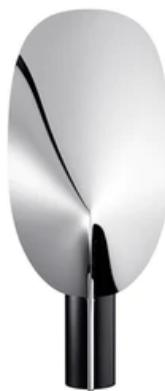
Dispositivo de iluminación de mesa con luz indirecta y reflejada. Disipador de aluminio extruido, cut off de policarbonato negro fotograbado, difusor de PMMA óptico fotograbado. Reflector de aluminio preanodizado trenzado y plegado. Cable eléctrico con una longitud útil de 200 cm, con interruptor para regular la intensidad, que garantiza las funciones de encendido y apagado (ON/OFF) y la regulación del flujo luminoso 10-100 %. Suministro eléctrico en clavija con enchufes intercambiables.
