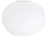
Aplique/plafón de luz difusa. Difusor compuesto por un cristal soplado opalino tratado al ácido, y una virola con rosca en aleación de aluminio fundición a presión, con acabado galvánico cromado. Base compuesta por un elemento estampado por inyección en poliamida reforzado con el 30% de fibra de vidrio y soporte del difusor en aleación de aluminio fundición a presión, pintado en color gris.
