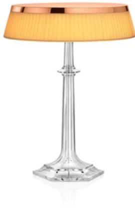
Lámpara de sobremesa que proporciona luz difusa. Base y difusor de polimetilmetacrilato transparente moldeado por inyección. Cubierta superior electrochapada en ABS. Fuente de luz de tecnología Edge Lighting. Longitud del cable de alimentación de 200 cm, con dimmer que proporciona funciones ON-OFF y 10-100% de ajuste de la luz. Fuente de alimentación enchufable con enchufes intercambiables.
