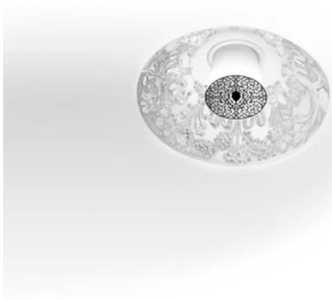
Lampe encastrée à lumière diffuse. Diffuseur hémisphérique en plâtre peint en blanc à l'intérieur. Support de diffuseur en alliage d'aluminium moulé sous pression. Diffuseur en verre soufflé opalin. Filtre en acier inoxydable (aisi 304 steel) photo-gravé puis travaillé mécaniquement.
