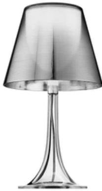
Lampe de table à lumière diffuse. Corps en PMMA (polyméthacrylate) entièrement transparent moulé par injection; diffuseur interne en PC (polycarbonate) opalin moulé par injection et diffuseur externe en PC (polycarbonate) moulé par injection aluminisé – sur la toute surface – avec un procédé d'aluminisation sous vide à l'intérieur.
