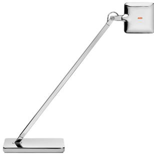
Lampe de table. Tête en fonte d'aluminium, diffuseur en métacrylate photogravé avec bord aluminisé. Alimentation sur prise, base en fonte de zamac. Tête orientable. Interrupteur ON/OFF avec technologie Soft Touch et réglage du flux lumineux double intensité (100% – 50% – 0%). Alimentation sur prise avec plug interchangeable.
