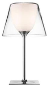
Lampe de table, pour l'intérieur, à lumière diffuse. Socle, support de tige et support de diffuseur en alliage de zamac moulé sous pression, poli et protégé par un vernis liquide transparent. Tige en tube d'aluminium poli et protégé par un vernis liquide transparent. Couverture du socle en PA (Nylon) moulé par injection, de couleur noir opaque. Diffuseur interne en PC (polycarbonate) moulé par injection, de couleur opalin injecté dans une proportion de 3%. Diffuseur externe en verre transparent.
