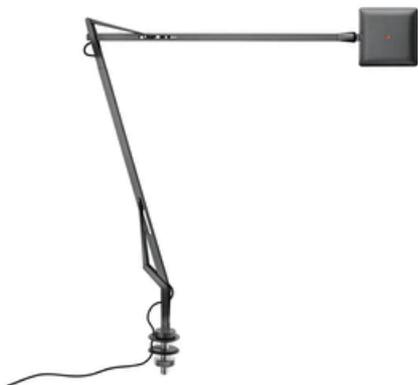
Lampe de table orientable à lumière directe. Corps en aluminium peint ou chromé; tête, joints et fourches moulés sous pression, bras extrudés. Diffuseur en polycarbonate photogravé et métallisé sur le bord. Source lumineuse de technologie Edge Lighting. Interrupteur optique placé sur la tête qui permet une variation à 3 niveaux et un réglage de la température de couleur de 2700 à 3200K. Câble électrique long. utile 150 cm. Bloc prise-transformateur avec fiches interchangeables.
