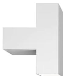
Wandleuchte mit direktem/indirektem Licht. Korpus aus lackiertem, extrudiertem Aluminium. Seitliche Verzierungen aus druckgepresstem Aluminium (45°) mit numerischer Steuerung für eine perfekte Verbindung mit dem Lampenkorpus. Diffusoren aus spritzgegossenem PMMA mit fotograviertem Finish. Wandbefestigung aus spritzgegossenem PA66. In den Korpus integriertes Netzgerät mit Mehrfachspannung.
