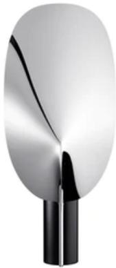
Tischbeleuchtungsgerät für indirektes und reflektiertes Licht. Dämpfer aus extrudiertem Aluminium, Ausschnitt aus schwarzem, fotograviertem PC, Diffusor aus optischem, fotograviertem PMMA. Reflektor aus pre-eloxiertem Aluminium in Streifen und gebogen. Die Nutzlänge des Kabels beträgt 200 cm. Es ist mit einem Dimmer-Schalter ausgestattet, der die ON/OFF-Funktionen sowie die Einstellung des Lichtstroms von 10-100% ermöglicht. Netzgerät mit Stecker und austauschbaren Anschlüssen.
