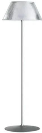
Stehleuchte für diffuses Licht. Interner Diffusor aus gepresstem und geätztem Borosilikatglas. Außenschirm aus transparentem Pressglas. Sockel und Kopfhalterung aus druckgegossener Aluminiumlegierung, Schaft aus Stahl, alle Elemente grau lackiert. Diffusorhalterung aus transparentem, spritzgegossenem Polycarbonat. Auf dem Kabel befindet sich der elektronische Dimmer, welcher eine schrittweise Einstellung der Lichtintensität.
