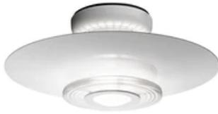
Deckenleuchte für reflektiertes und diffuses Licht. Reflektor aus glänzend weiß pulverlackiertem Aluminiumguss. Spezielle Halterungsplatte aus Stahlguss für strahlenförmigen Lichtaustritt. Diffusor aus sandgestrahltem Pressglas und klarer Glaslinse. Deckenhalterung aus druckgegossener, mattschwarz flüssiglackierter Aluminiumlegierung und Baldachin aus glänzend weiß pulverlackiertem Aluminiumguss.
