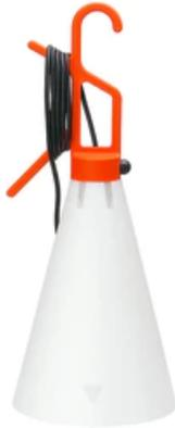
Mehrzweckleuchte. Kegelförmiger Diffusor aus opalfarbenem, spritzgegossenem Polypropylen. Aufhängöse/Griff, gleichzeitig Kabelaufwickler, aus zu 10% talksteinverbundenem, spritzgegossenem Polypropylen. Bedienungstaste am Griff. Schalterschutz aus spritzgegossenem Elastomer.
