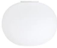
Wand- oder Deckenleuchte für diffuses Licht. Diffusor bestehend aus mundgeblasenem Opalglas mit geätzter Außenfläche und einem Abdeckring mit Gewinde aus druckgegossener Aluminiumlegierung, galvanisch alodineverchromt. Sockel bestehend aus einem zu 30% glasfaserverstärktem, spritzgegossenem Polyamidelement und der Diffusorhalterung aus druckgegossener, grau lackierter Aluminiumlegierung.
