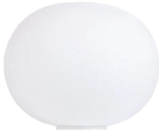
Tischleuchte für diffuses Licht. Diffusor bestehend aus mundgeblasenem Opalglas mit geätzter Außenfläche und einem Abdeckring mit Gewinde aus druckgegossener Aluminiumlegierung, galvanisch alodine-verchromt. Sockel bestehend aus einem zu 30% glasfaserverstärktem, spritzgegossenem Polyamidelement und der Diffusorhalterung aus druckgegossener, grau lackierter Aluminiumlegierung. Auf dem Kabel befindet sich der elektronische Dimmer, welcher eine schrittweise Einstellung der Lichtintensität.
