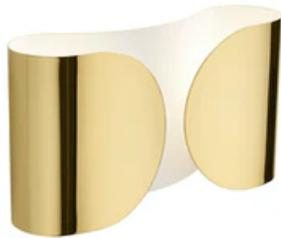
Wandleuchte für direktes/indirektes/teilweise diffuses Licht. Die Wandhalterung ist aus geschnittenem, gebogenem und glänzend weiß pulverlackiertem Stahl. Diffusor aus pulverlackierte schnittmetall. Die beiden Fassungenhalterungen sind aus weißem, spritzgepreßtem Nylon.
