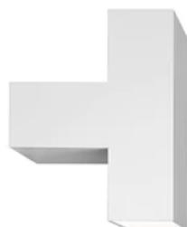
Applique a luce diretta/indiretta. Corpo in alluminio estruso verniciato. Fregi laterali in alluminio pressofuso ripreso a 45° su controllo numerico per avere un perfetto accoppiamento con il corpo lampada Diffusori in PMMA stampato ad iniezione con finitura fotoincisa. Attacco a parete in PA66 stampato ad iniezione. Alimentatore multitemperatura integrato nel corpo.
