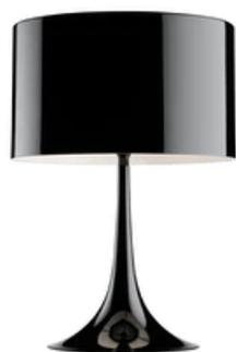
Lampada da tavolo a luce diffusa. Corpo e diffusore in metallo tornito in lastra, bracci supporto diffusore e supporto portalampada in lega d'alluminio pressofuso, tutti verniciati a liquido nei colori sottoindicati. I supporti diffusore sono in policarbonato bianco stampato ad iniezione. Schermo diffusore superiore in vetro pressato con finitura sabbata. Sul cavo è presente il dimmer elettronico che consente la regolazione a step dell'intensità luminosa.
