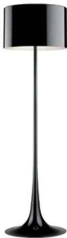
Apparecchio di illuminazione da terra a luce diffusa. Corpo e diffusore in metallo tornito in lastra, bracci supporto diffusore e supporto portalampada in lega d'alluminio pressofuso, tutti verniciati a liquido nei colori sottoindicati. I supporti diffusore sono in policarbonato bianco stampato ad iniezione. Sul cavo è presente il dimmer elettronico che consente la regolazione a step dell'intensità luminosa.
