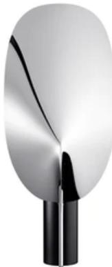
Apparecchio di illuminazione da tavolo a luce indiretta e riflessa. Dissipatore in alluminio estruso, cut-off in PC nero fotoinciso, diffusore in PMMA ottico fotoinciso. Riflettore in alluminio pre-anodizzato tranciato e piegato. Cavo elettrico lunghezza utile 200 cm, con interruttore dimmer che garantisce le funzioni ON/OFF e regolazione del flusso luminoso 10-100%. Power supply su spina con plug intercambiabili.
