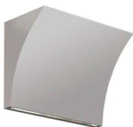
Lampada da parete a luce diretta/indiretta. Corpo in lega di zama pressofusa, verniciata a liquido nei colori grigio opaco, bianco lucido oppure con finitura cromata in galvanica. Attacco a parete in acciaio stampato e zincato bianco, riportante sia il sistema di fissaggio a parete, che i dispositivi elettrici.
