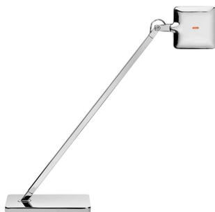
Apparecchio di illuminazione da Tavolo. Testa in alluminio pressofuso, diffusore in metacrilato fotoinciso con cornice alluminata. Alimentatore su spina, base in zama pressofusa. Testa orientabile. Interruttore ON/OFF con tecnologia Soft Touch e regolazione del flusso luminoso a 2 intensità (100% – 50% – 0%). Alimentatore su spina con plug intercambiabili.
