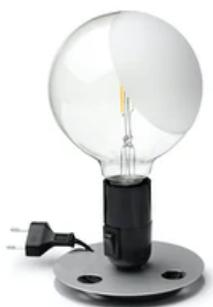
Lampada da tavolo a luce diretta/diffusa. Base in alluminio anodizzato, avente anche la funzione di riavvolgitore del cavo elettrico. Porta lampadina in bachelite e, per il colore arancio, con verniciatura a liquido. Lampadina globolux vetro trasparente con una parziale sabbiatura su un lato della sfera.
