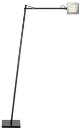
Apparecchio di illuminazione da Terra. Testa in alluminio pressofuso, diffusore in PC. Alimentatore su spina, copertura base in PC stampato ad iniezione, contrappeso in ferro tranciato e verniciato attraverso processo di cataforesi. Testa orientabile. Interruttore ON/OFF con tecnologia Soft Touch a tre step. Base separata dal corpo lampada con grano di sicurezza.
