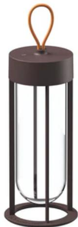
Apparecchio di illuminazione per installazione a terra per uso esterno. Diffusore opalino integrato nella testa e vetro estetico di protezione esterno in borosilicato trasparente. Le parti strutturali dell'apparecchio sono realizzate in alluminio pressofuso ed estruso trattato con procedimento di conversione chimica al fine di una efficiente resistenza agli agenti atmosferici. Il corpo è verniciato a polvere e disponibile in varie finiture.
