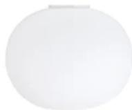
Lampada da soffitto o parete a luce diffusa. Diffusore composto da un vetro opalino incamiciato, soffiato a bocca, con finitura esterna acidata e da una ghiera filettata in lega di alluminio pressofusa, con finitura galvanica "cromatazione alodine". Base composta da un elemento stampato ad iniezione in poliammide rinforzato con il 30% di fibra di vetro e supporto diffusore in lega di alluminio pressofusa, verniciato di colore grigio a liquido.
