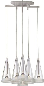
Lampada a sospensione a luce diretta. N° 8 diffusori in vetro, con forma conica, soffiati a bocca e sabbiati nella parte terminale. Anelli OR di protezione dei diffusori in silicone opalino stampati ad iniezione (UL-94 V0). Corpi in tubolari di acciaio verniciati di colore bianco lucido a polvere. Assieme rosone composto di N.8 bracci in alluminio estruso e tappi laterali in poliammide caricata con il 30% di fibra di vetro stampati ad iniezione. Attacco a plafone di acciaio stampato e zincato.
