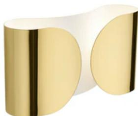
Lampada da parete a luce diretta/indiretta/parzialmente diffusa. L'attacco a muro è in acciaio tranciato, piegato e verniciato a polvere di colore bianco lucido. Diffusore in acciaio tranciato, curvato e verniciato a polvere. I due supporti portalampana sono in nylon, stampato ad iniezione di colore bianco.
