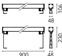
Apparecchio da esterni per installazione a parete o soffitto con fonte di luce a LED.
