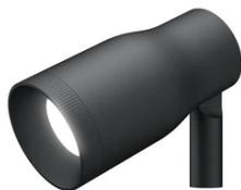
Proiettore IP65 per uso esterno composto da un corpo in alluminio tornito e alimentato a 24V, disponibile con temperature di colore da 2700K, 3000K e 4000K. Sull'asse orizzontale, è possibile orientare il faretto fino a 30° verso il basso e fino a 90° verso l'alto. I faretti Landlord sono disponibili in due dimensioni, con testa ø40 e ø50, entrambe dotate di ghiera anteriore smontabile, per installare lenti flood oppure fino a due honeycomb per il massimo comfort visivo.
