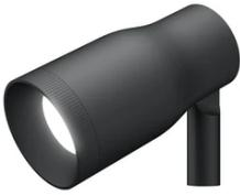
Proiettore IP65 per uso esterno composto da un corpo in alluminio tornito e alimentato a 24V, disponibile con temperature di colore da 2700K, 3000K e 4000K. Sull'asse orizzontale, è possibile orientare il faretto fino a 30° verso il basso e fino a 90° verso l'alto. I faretti Landlord sono disponibili in due dimensioni, con testa ø40 e ø50, entrambe dotate di ghiera anteriore smontabile, per installare lenti flood oppure fino a due honeycomb per il massimo comfort visivo.
