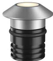
Apparecchi d'illuminazione IP67 da incasso a terra, alimentato a 24V. Corpo in alluminio anodizzato e poi resinato, anello esterno in acciaio inossidabile pallinato, che contiene tutta l'elettronica di controllo. Testa disponibile in due dimensioni, Ø49 mm e Ø64 mm, con emissione frontale o radente (uno, due o quattro fasci).
