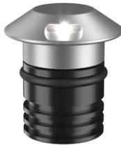
Apparecchi d'illuminazione IP67 da incasso a terra, alimentato a 24V. Corpo in alluminio anodizzato e poi resinato, anello esterno in acciaio inossidabile pallinato, che contiene tutta l'elettronica di controllo. Testa disponibile in due dimensioni, Ø49 mm e Ø64 mm, con emissione frontale o radente (uno, due o quattro fasci).
