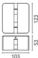
Apparecchio per esterni installabile in vano finestra con fonte di luce a LED.
