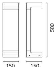
Il corpo delle versioni C è realizzato in alluminio estruso, base e diffusore in alluminio pressofuso EN AB-47100 a basso contenuto di rame.
