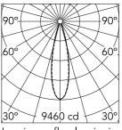
Luminous flux luminaire 2201 lm
