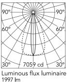
13° Beam Angle: E(Ix) D(m) h(m) 0.22 7059 1 2 1765 0.44 3 784 0.66 0.88 4 441 5 282 1.10
