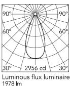
45° Beam Angle: E(Ix) D(m) h(m) 2956 0.83 1 2 739 1.65 3 328 2.48 3.31 4 185 5 118 4.13
