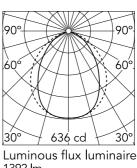
82° Beam Angle: E(Ix) D(m) h(m) 1.74 636 1 2 159 3.49 3 71 5.23 6.98 4 40 5 25 8.72
