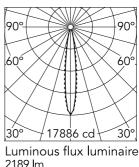
14° Beam Angle: E(Ix) D(m) h(m) 17886 0.25 1 2 4472 0.50 3 1987 0.74 0.99 4 1118 5 715 1.24
