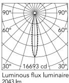
14° Beam Angle: E(Ix) h(m) D(m) 0.25 16693 1 2 4173 0.50 3 1855 0.74 0.99 4 1043 5 668 1.24
