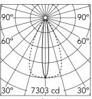
Luminous flux luminaire 2066 lm
