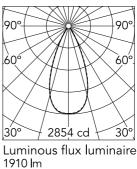
45° Beam Angle: E(Ix) D(m) h(m) 2854 0.83 1 2 714 1.65 3 317 2.48 3.31 4 178 5 114 4.13
