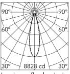
Luminous flux luminaire 2054 lm
