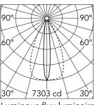
Luminous flux luminaire 2066 lm
