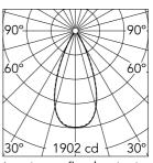
Luminous flux luminaire 1273 lm
