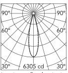
Luminous flux luminaire 1467 lm
